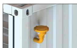
**Protiexplozivní pojistka:** Naftová nádrž má provedené odvětrání mimo konstrukci kontejneru. Ukončení odvětrání je osazeno neprůbojnou protiexplozivní pojistikou.
