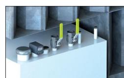
**Čidla:** Pro indikaci všech stavů v naftové nádrži jsou vestavěna do nádrže čidla. V nádrži je vždy čidlo pro indikaci stavu mezipláště a kapacitní čidlo pro snímání hladiny paliva (na přání lze i ultrazvukové). Pro indikaci úniků provozních kapalin motorgenerátoru či paliva je v podlahové jímce mimo palivovou nádrž osazeno čidlo zaplavění.
